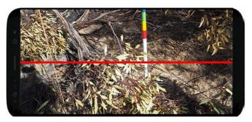
FIGURE 3. SCREENSHOT TAKEN FROM FUELS3D ANDROID SHOWING AN EXAMPLE IN-FIELD TARGET IN THE BACKGROUND.
