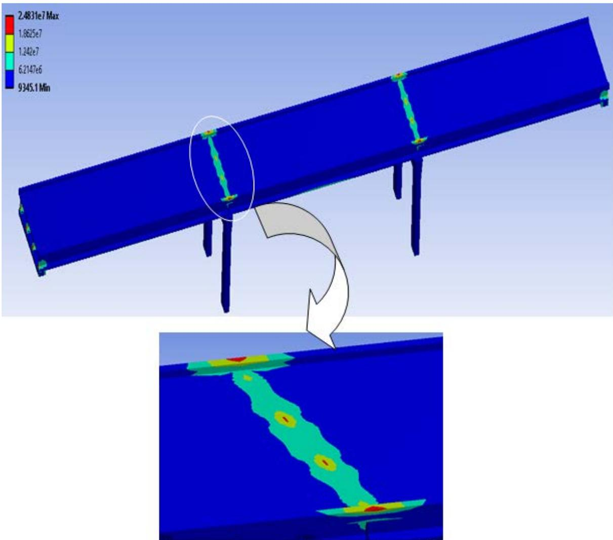
FIGURE 7: MAXIMUM STRESSES AT THE DECK JOINT DUE TO A TYPICAL EARTHQUAKE
