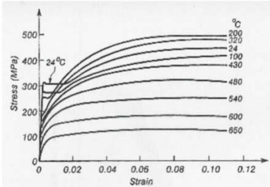
FIGURE 26: STRESS-STRAIN CURVE FOR TYPICAL HOT ROLLED STEEL AT ELEVATED TEMPERATURES[107]
