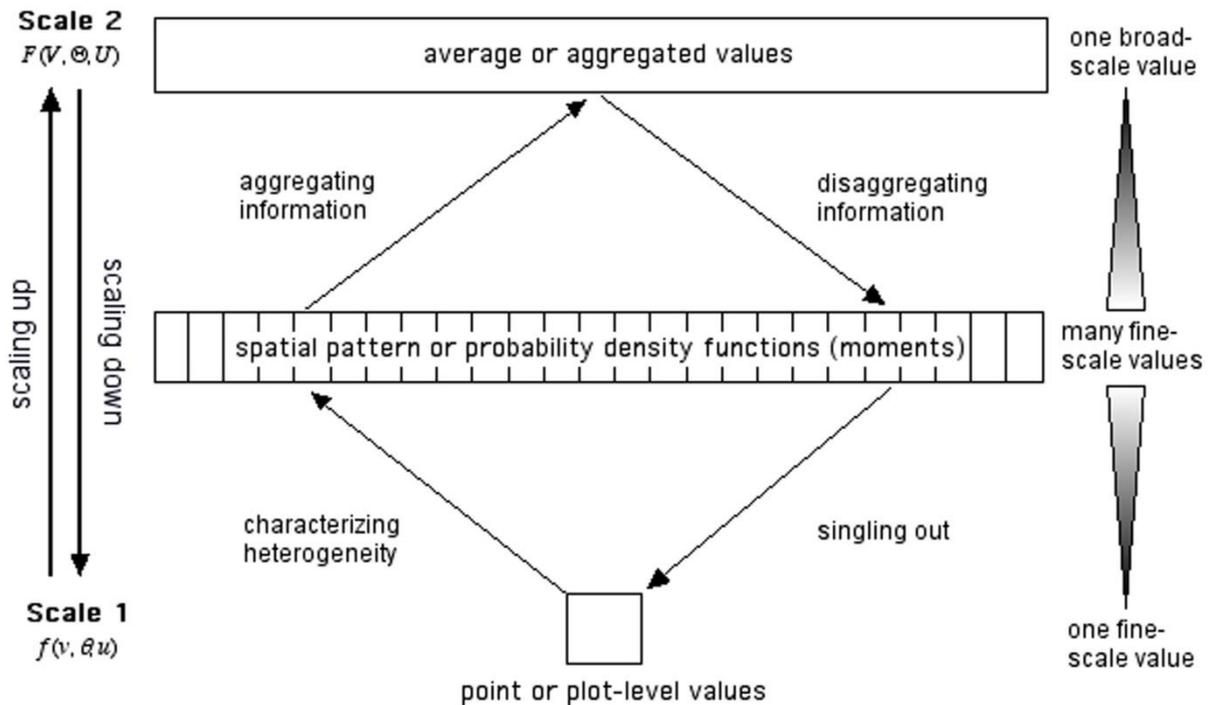
**Figure 2.** Two-Step Scaling Procedure (Courtesy: Blöschl & Sivapalan, 1995)
